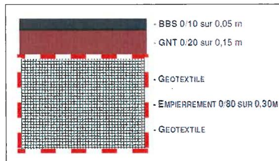
La couche de base est constituée de Grave Non Traité (GNT) sur 15cm recouvert de Béton Bitumineux Souples (BBS) sur 5cm.
