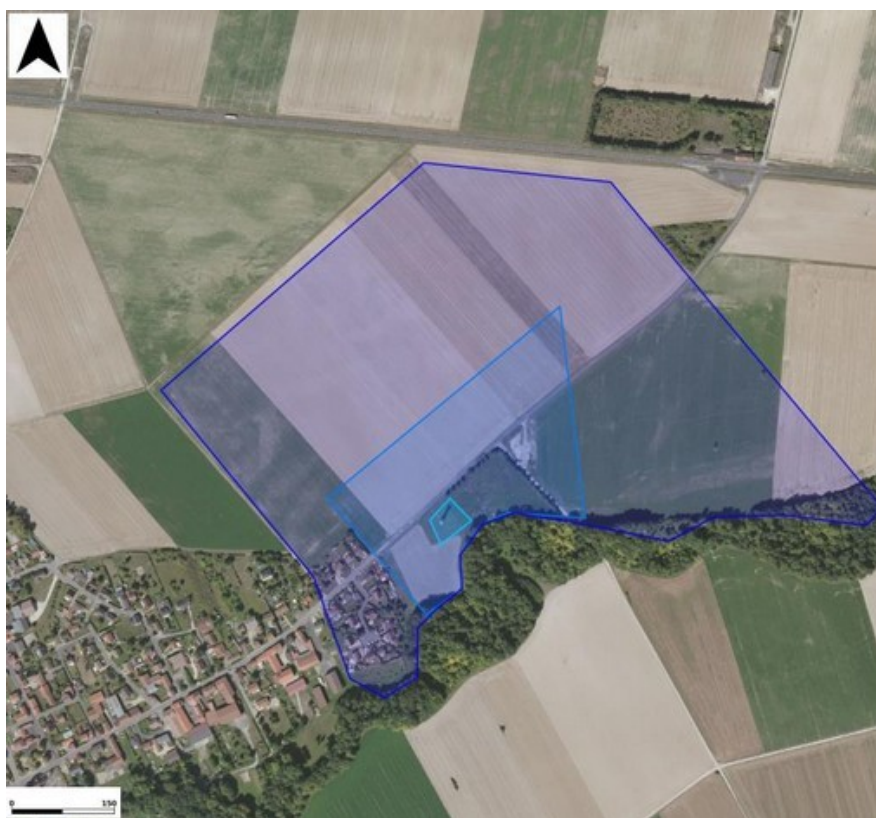
Périmètres de protection du captage de Prosnes
